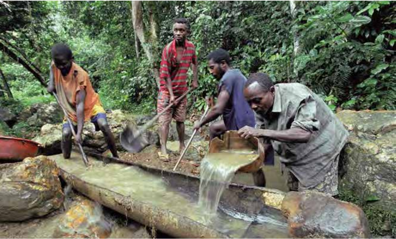
Die Minenarbeiter schieben immer wieder die coltanhaltige Erde auf die schiefe Ebene. Durch die ständige Zufuhr von Wasser trennt sich der Abraum vom Coltan, welches dann am Boden der Rinne zurückbleibt.
